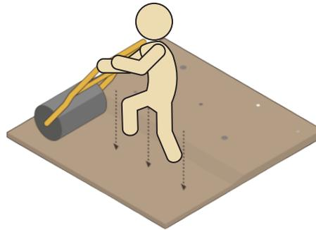
Coloca la malla anti hierbas y encima presenta tu césped en el suelo (sin pegar). Recuerda, tu césped tiene una pila direccional, por lo que todo deberá mirar de la misma manera si tiene uniones.
